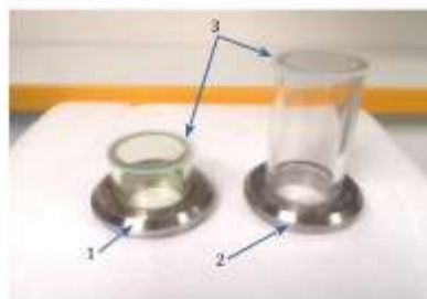
Figure 4 — Chambre tubulaire de sédimentation fixe. 1: chambre avec colonne fixe de 10 mL, 2 : chambre avec colonne fixe de 25 mL, 3 : lamelles épaisses
