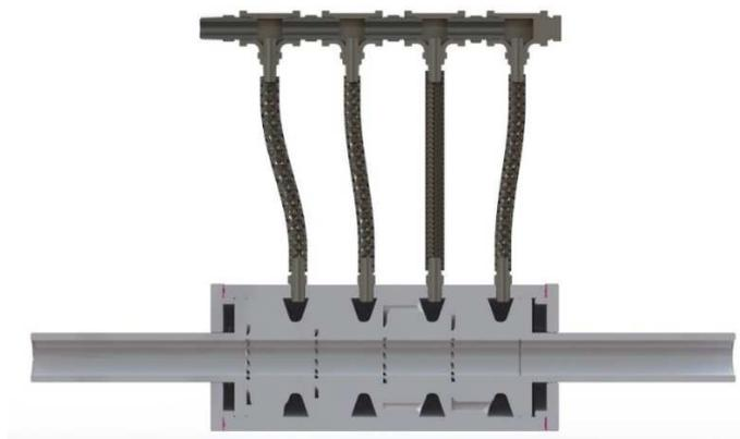
Рисунок 2. Общий вид вихревого смесительного устройства
