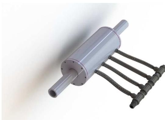
Рисунок 3. Общий вид вихревого смесительного устройства
