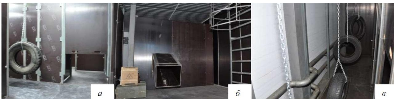
**Рисунок 2. Участок планировки дымокамеры (лабиринт) (а), участок планировки дымокамеры (туннель) (б) и участок планировки дымокамеры (вертикальные препятствия) (в)**
