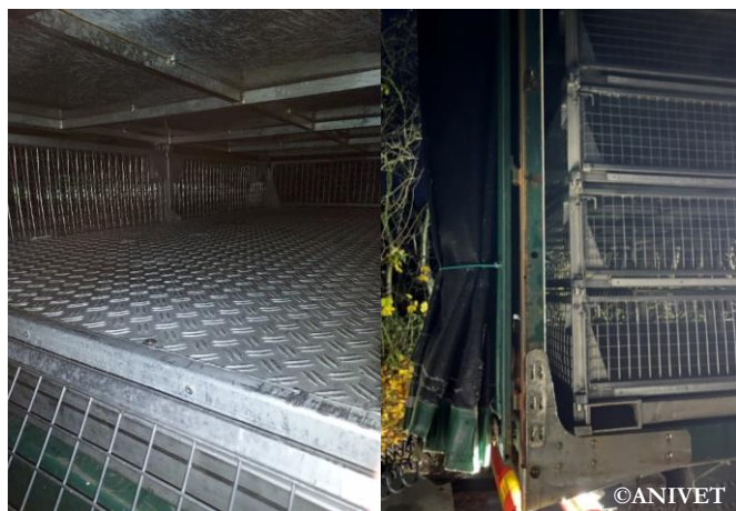
A gauche: le sol des conteneurs; A droite: les rideaux en position de stockage
