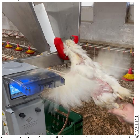
Figure 6 : La tête de l'oiseau est introduite entre les électrodes de l'assommeur.
