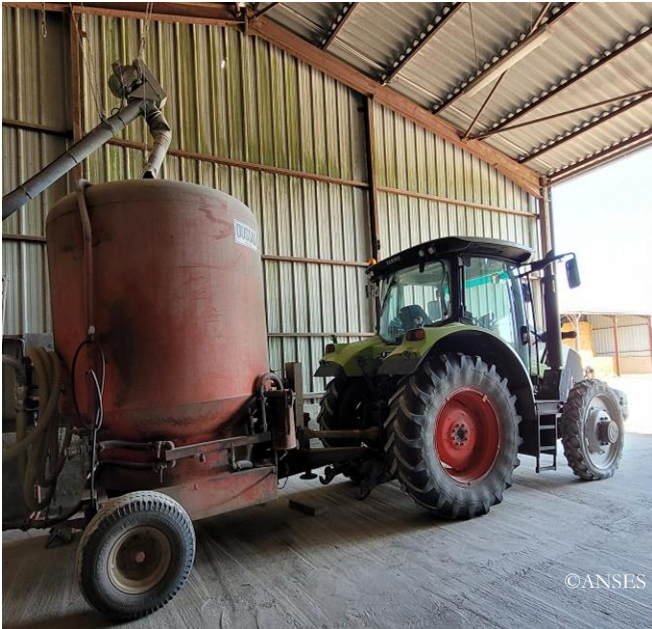
Rys. 11. Ciągnik z automatycznym systemem dystrybucji paszy.
