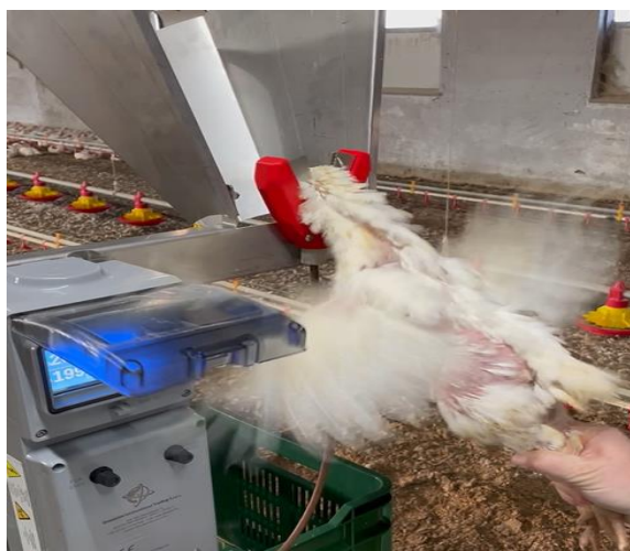
Rys. 6: Głowa ptaka jest wprowadzana między elektrody
