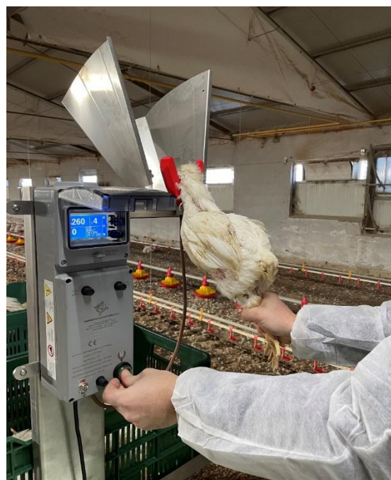
Rys 2: Ogłuszanie elektryczne tylko przez głowę ptaka
