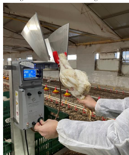
Abbildung 2: Individuelle elektrische Betäubung mittels Kopfdurchströmung
